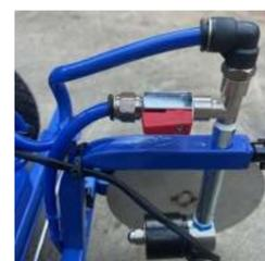
4. Fermer le robinet à boisseau sphérique pour permettre à la solution de peinture de passer à travers l'électrovanne et la buse.
