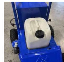
2. Branchez le tuyau de la lance d'aspiration dans le système FastClean™. Insérez la lance d'aspiration dans le tambour de peinture RTU et vissez le couvercle. Assurez-vous que la vanne FastClean™ est réglée sur 'Spray'.
