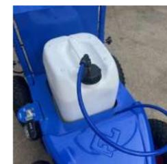
3. Ouvrez le robinet à boisseau sphérique et activez le marqueur de ligne pendant environ 5 secondes pour permettre à la solution de peinture d'être pompée, d'éliminer l'air emprisonné et d'amorcer la pompe.
