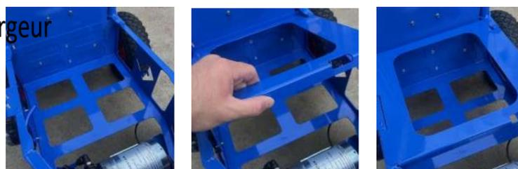
8. Installer le berceau en veillant à ce que les languettes arrière soient sous le cadre.
